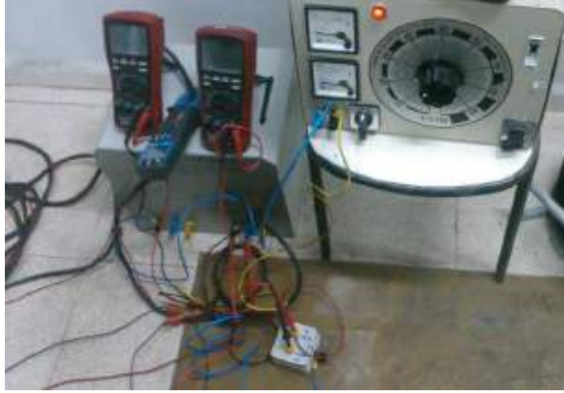
Şekil 4. Selvaz Metodu ile Kurulan Toprak Empedans Devresi
